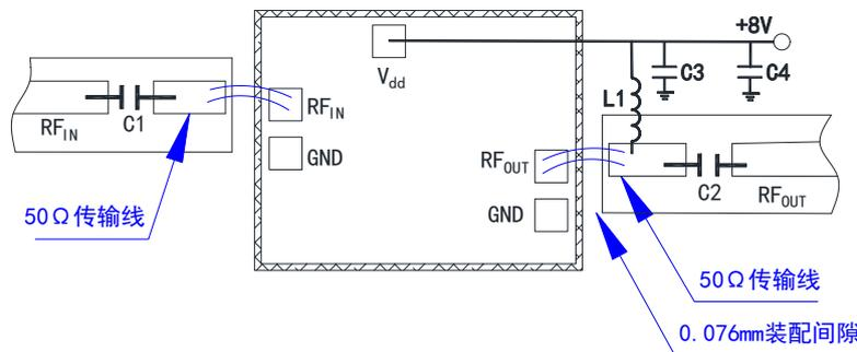
注: 射频端口应尽量靠近微带线以缩短键合金丝尺寸, 典型的装配间隙是 0.076~0.152mm, 使用  $\Phi 25\mu\text{m}$  双金丝键合, 建议金丝长度 250~400 $\mu\text{m}$ 。
