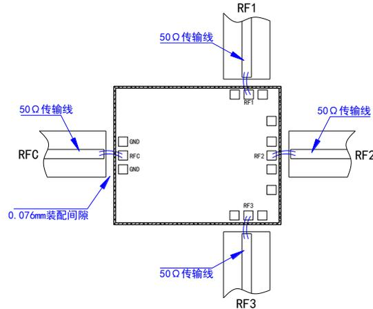
注：射频端口应尽量靠近微带线以缩短键合金丝尺寸，典型的装配间隙是 0.076~0.152mm，使用  $\Phi 25\mu\text{m}$  双金丝键合，建议金丝长度 250~400 $\mu\text{m}$ 。
